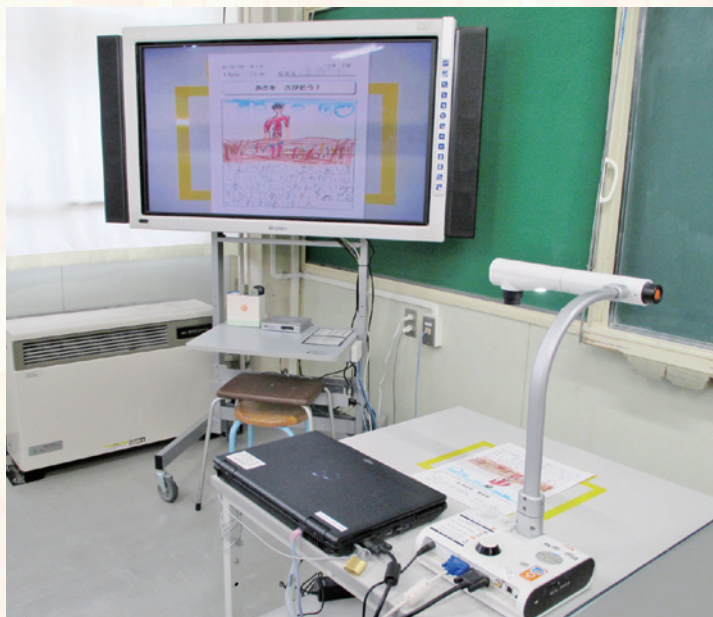
■ICT機器の常設・固定（左から、大型提示装置／ノートPC／実物投影機。台の広さは70 cm×70 cm。）
